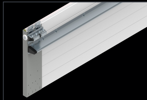
Dubbele eindkap + zijscharnieren met strut 75 mm (vanaf 6000 mm)
